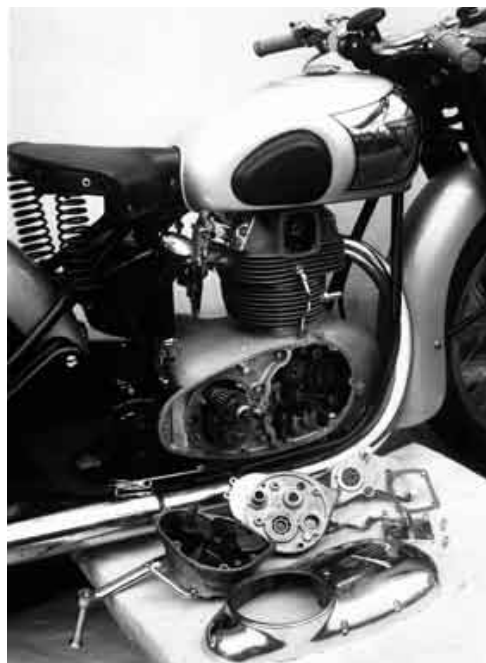
Cambio in blocco estraibile della M.M. 350 CT, 1951
