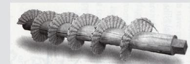
Tracciatura del cilindro interno della coclea con otto eliche inclinate di 45°
