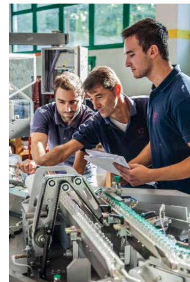
Tecnici Marchesini al lavoro sul gruppo di alimentazione di un'astucciatrice continua, 2013
