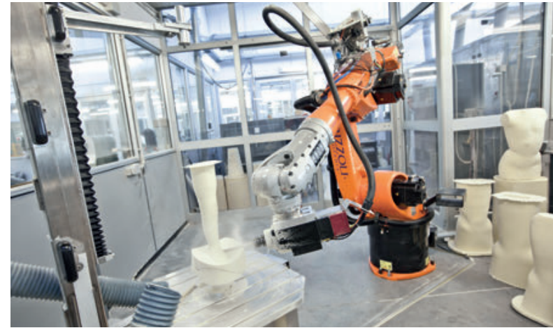
Officine Ortopediche Rizzoli oggi: braccio meccanico a 6° di libertà per la fresatura di positivi per protesi Archivio Officine Ortopediche Rizzoli
