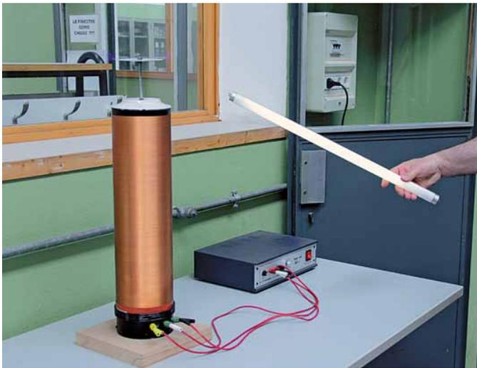
Laboratorio di Elettrotecnica ed Automazione. Bobina di Tesla, dispositivo in grado di generare campi elettromagnetici ad alta frequenza ed alta tensione
