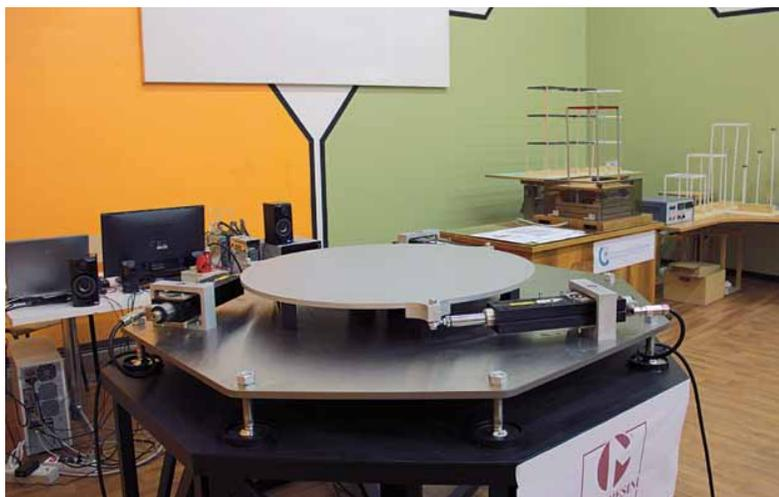
Mostra "Io non tremo". Laboratorio di dinamica delle strutture sottoposte ad azione sismica. In primo piano, piattaforma vibrante; sulla destra, alcuni modelli di tavole vibranti
