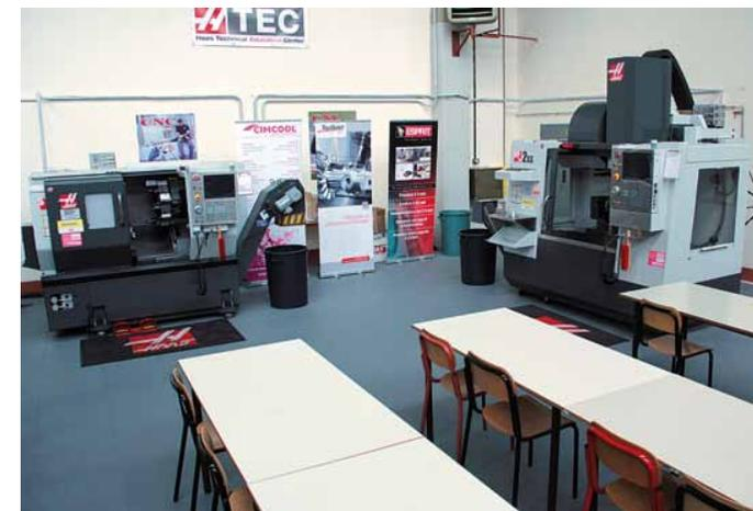
Laboratorio di Macchine utensili a controllo numerico. A sinistra, tornio a 3 assi con utensili motorizzati Haas ST 10; a destra, centro di lavoro a 5 assi Haas VF 2ss con robotascala TR 160
