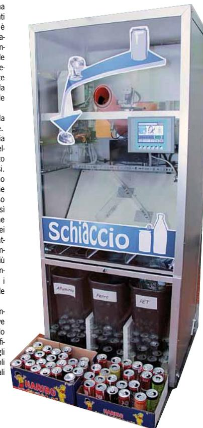
Laboratorio di Elettrotecnica ed Automazione. Compattatore ecologico "Schiaccio", 5° classificato al Concorso Siemens "Olimpiadi dell'Automazione" 2012
