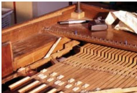
Più anteriormente (ricostruzione) è incollato un piccolo blocchetto di faggio su cui è incernierata con pelle la leva dello smorzatore (faggio).
