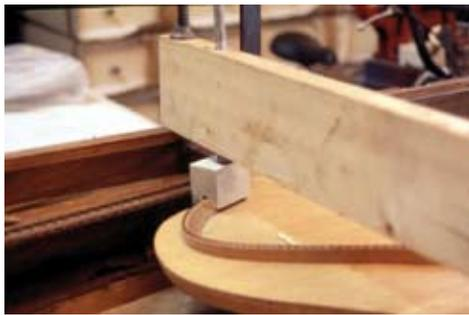
*L'incollaggio del ponticello, un supporto, non visibile, sostiene la tavola all'interno*
